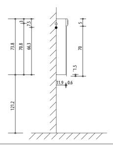
Montageschiene + Stromanschluss Rail de suspension + Branchement électrique Guida di montaggio + Alimentazione
