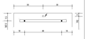
Position Steckdosen Position prises de courant Posizione prese di corrente
