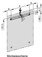
Montageschiene Rail de suspension Guida di montaggio
