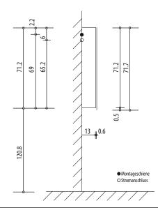
Montageschiene + Stromanschluss Rail de suspension + Branchement électrique Guida di montaggio + Alimentazione
