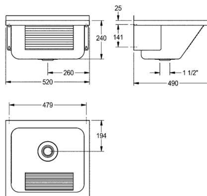
Évier à usage universel, conçu pour une installation murale, en inox, finition satinée, épaisseur du matériau de 0,9 mm, panneau frontal nervuré, bonde à bouchon 1 1/2" centrée, avec trop-plein, remontée arrière de 30 mm, supports de montage pré-soudés. Vis en inox et chevilles fournies.
