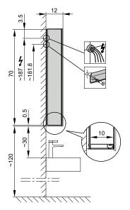
Aufputz-Montage Pose en applique Surface mounting
