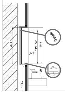
Unterputz-Montage mit UP-Einbaurahmen Pose en encastrement avec cadre de montage Recessed mounting with installation box
