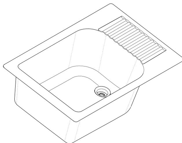
Montageschrauben M5 x 25 (Senkkopf) bei einer Arbeitsplatten-Dicke von 22 mm.
