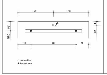
Position Steckdosen Position prises de courant Posizione prese di corrente
