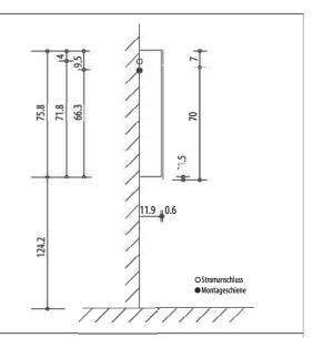
Montageschiene + Stromanschluss Rail de suspension + Branchement électrique Guida di montaggio + Alimentazione
